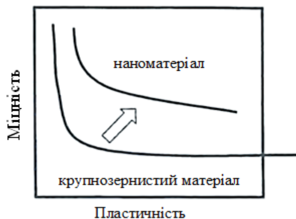
Рис. 12. Залежність між міцністю та пластичністю для об'ємних і нанорозмірних матеріалів
