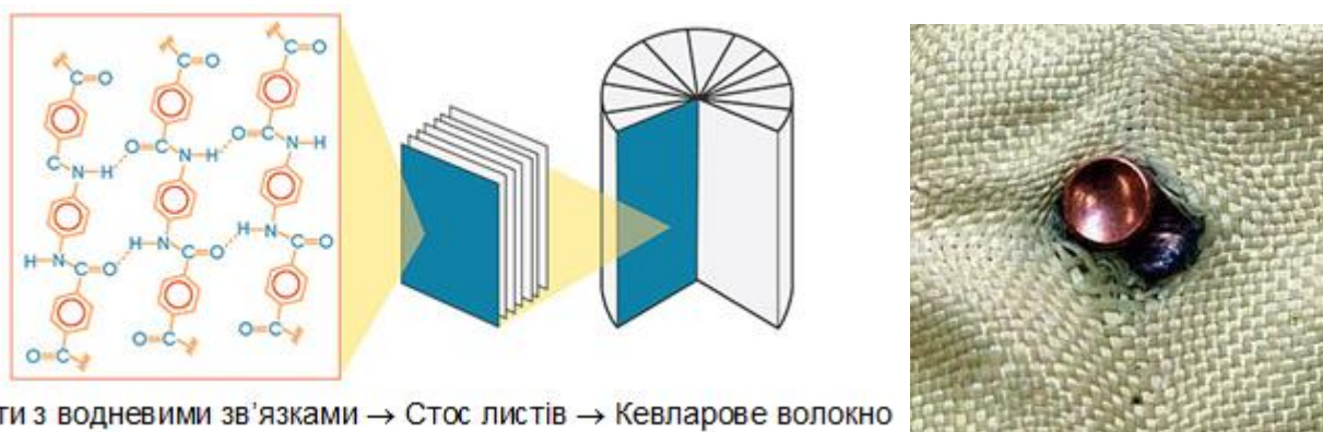
Рис. 29. Кевлар найвідоміше і міцне хімволокно, яке одержують за традиційною технологією і використовують у бронежилетах
