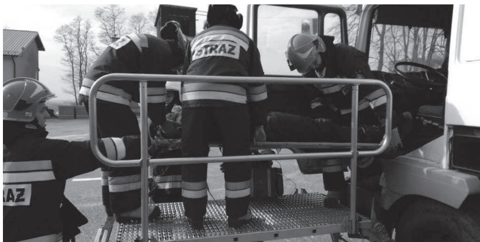
Fot. 5c. Podest ewakuacyjny – ustawienie bokiem krótkim do drzwi, barierka zabezpieczająca ustawiona w kierunku tyłu pojazdu, dalszy etap ewakuacji
