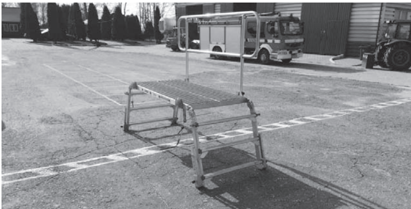
Fot. 3a. Podest ewakuacyjny – rozłożony, różne poziomy wysokości
