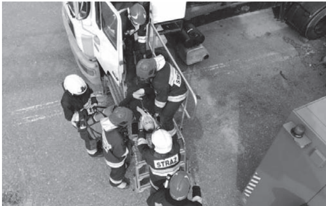
Fot. 5a. Podest ewakuacyjny – ustawienie bokiem krótkim do drzwi, barierka zabezpieczająca ustawiona w kierunku tyłu pojazdu, widok z góry
