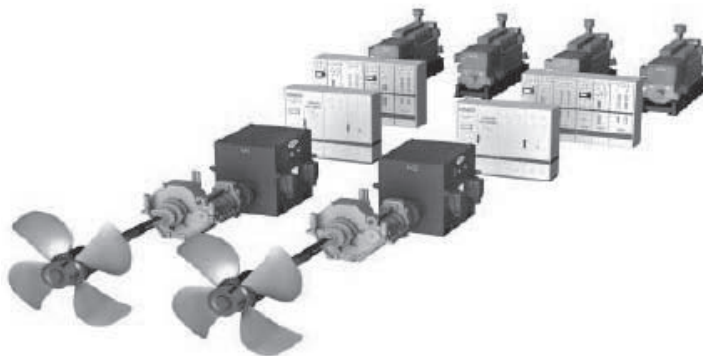
Ryc. 7. Napęd spalinowo-elektryczny ze śrubą konwencjonalną
