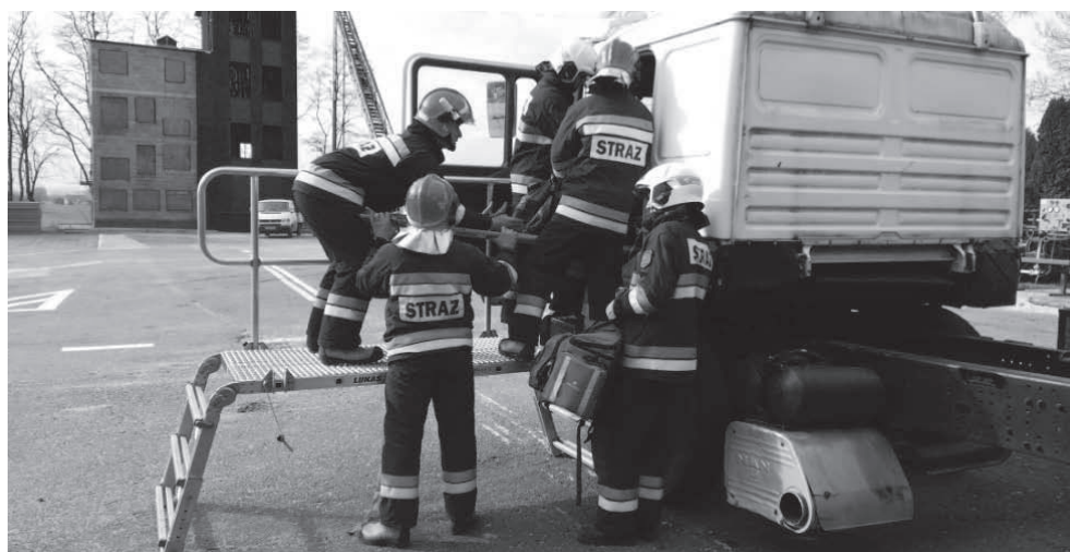
Fot. 6. Podest ewakuacyjny – ustawienie bokiem krótkim do drzwi, barierka zabezpieczająca ustawiona w kierunku przodu pojazdu
