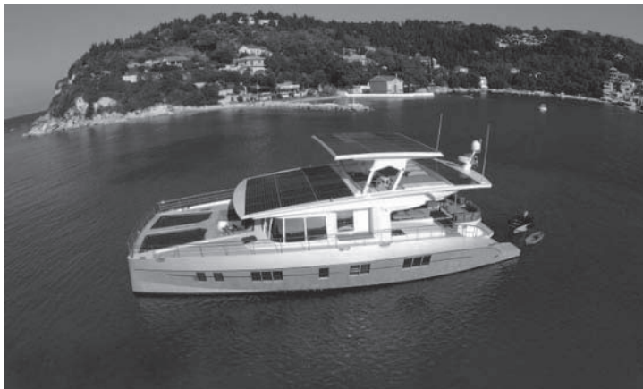
Ryc. 9. Katamaran z zainstalowanymi panelami fotowoltaicznymi
