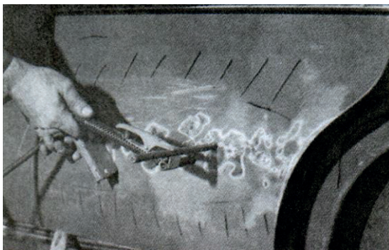
Рис. 5.32. Усунення здуття з допомогою вугільного електроду
