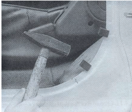
Рис. 6.4. Використання монтажних скоб для фіксації з'єднаних елементів кузова
