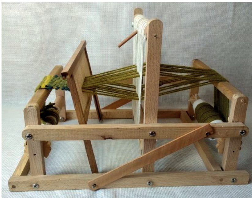
Рис. 68. Утворення другого зіву на верстатику.
