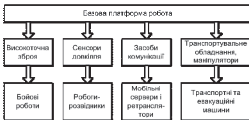
Рис. 4.2. Спеціалізація мобільних роботів на основі базової платформи
