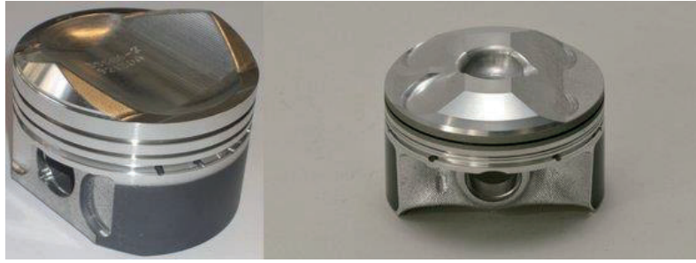
Рис. 4.10. Форма днища поршнів двигунів з безпосереднім впорскуванням
