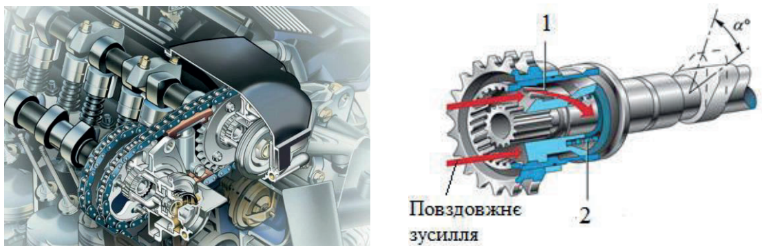
Рис. 1.28. Схема роботи механізму зміни фаз газорозподілу з поворотом вала:
