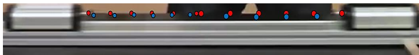
Рис. 2. Об'єднаний рисунок зі всіма проміжними положеннями візків, отриманий засобами Wolfram Mathematica: круг меншого розміру відповідає положенню першого візка; круг більшого розміру – положенню другого візка; круг червоного кольору відповідає положенню візка до пружного зіткнення; круг синього кольору – положенню візка після пружного зіткнення
