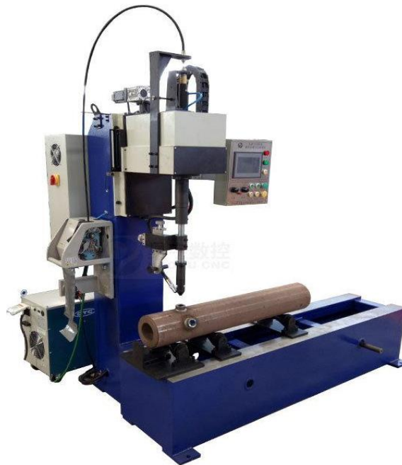
Рис. 2. Автоматична зварювальна установка фітингів китайського виробника HAOYU [4]
