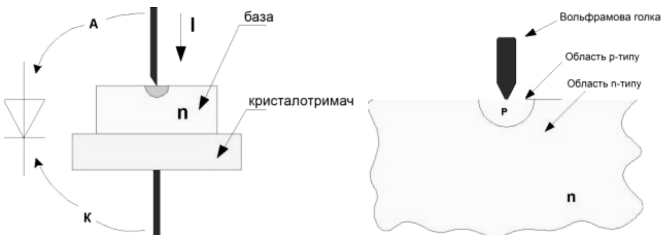
Рис. 12.6. Конструкція точкового діода
