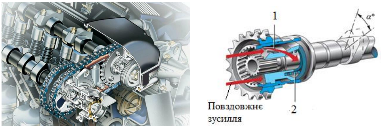
Рис. 1.10. Схема роботи механізму зміни фаз газорозподілу з поворотом валу: 1 – втулка зі спіральними зубами; 2 – пружина; \alpha^\circ – діапазон зміни фаз газорозподілу
