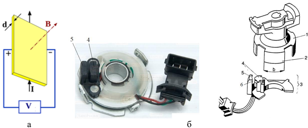
Рис. 8.9. Елементи датчика-розподільника з датчиком Холла:
