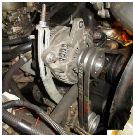
Рис. 6.7. Пасовий привод автомобільних генераторів
