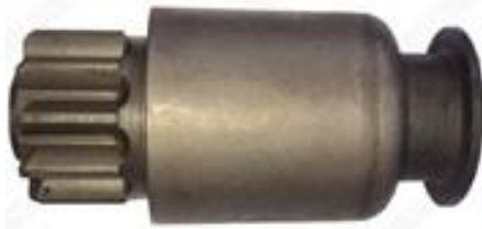
Рис. 7.3. Храпова муфта привода стартера КамАЗ:
