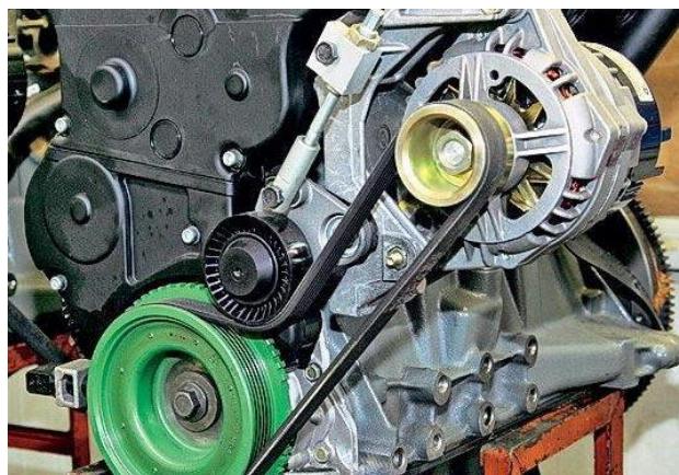
Рис. 6.7. Пасовий привод автомобільних генераторів
