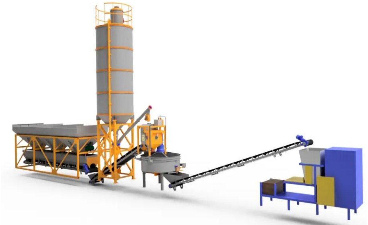
Рис. 3.2. Розчино-бетонний вузол для автоматизованої лінії з виробництва тротуарної плитки.
