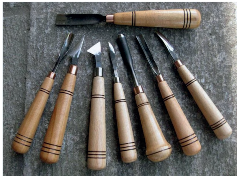
Рис. 2.15. Різновиди ножів і стамесок для різьблення деревини
