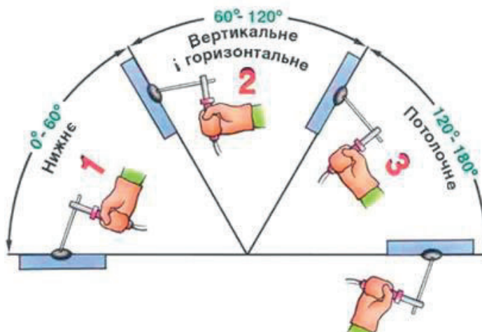
Рис. 6. Просторове розташування зварних швів
