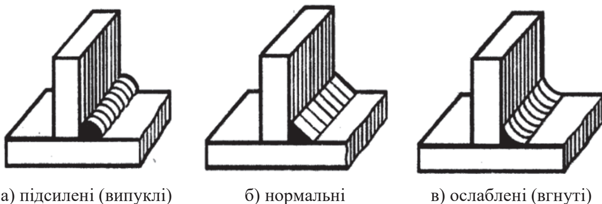
Рис. 1.3. Зварні з'єднання за формою одержуваного поперечного шва
