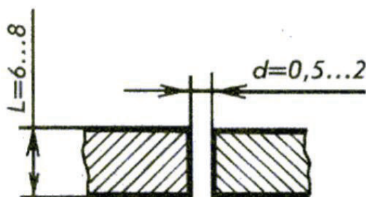
Рис. 1.4. Підготовка кромки металу товщиною до 8 мм до зварювання
