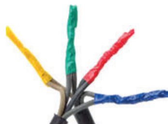
Рис. 10. Ізолювання спаяних проводів
