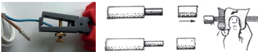
Рис. 7. Ізолювання та очищення проводів
