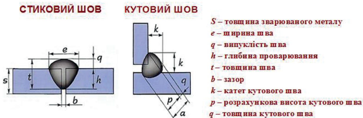
Рис. 5. Стикові і кутові шви та їх геометричні параметри
