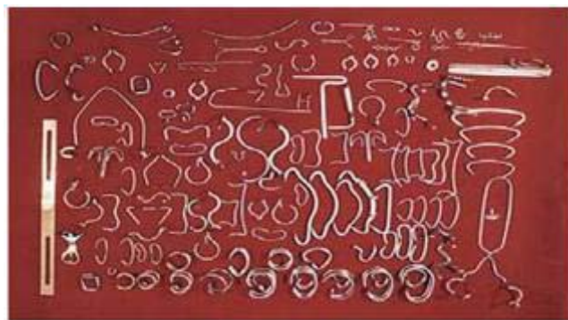
Рис. 1.4. Набір імплантів з нікеліду титану для травматології (у вигляді скоб, скрепів, фіксаторів)
