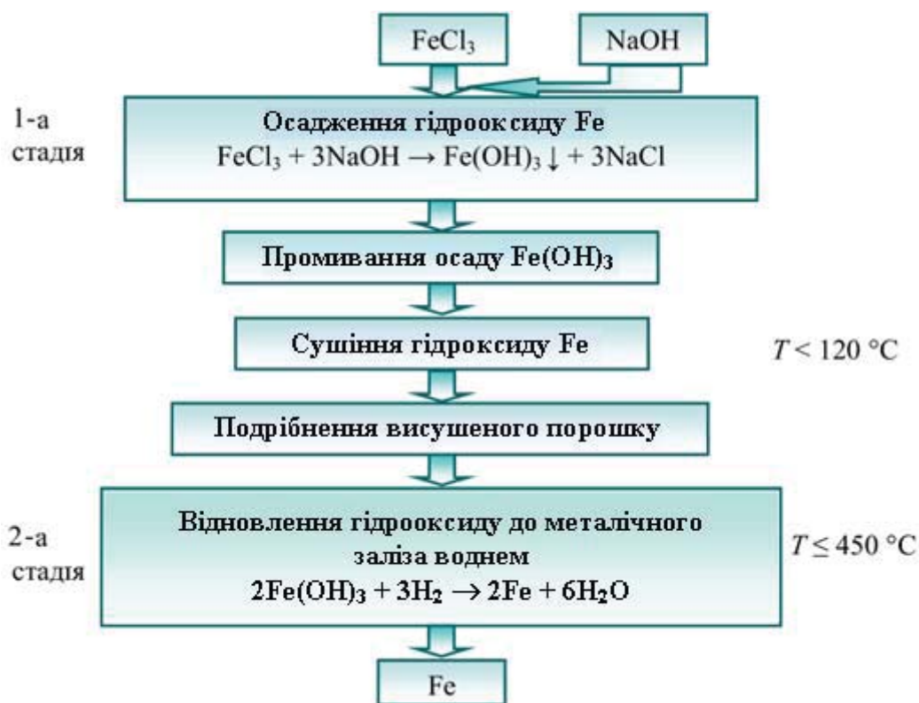
Рис. 1.7. Технологічна схема отримання нанопорошку заліза хіміко-металургійним методом
