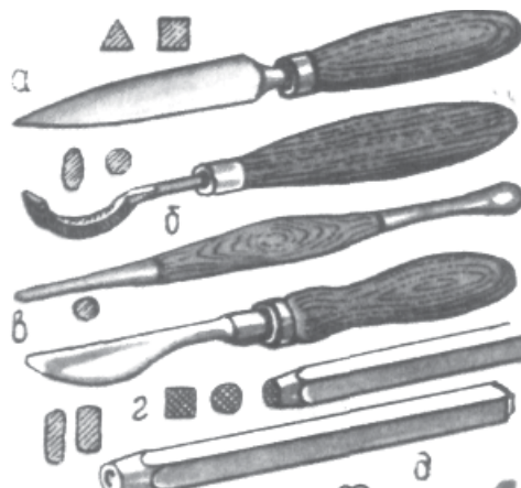
Рис. 1.11. Інструменти для виправлення і декоративної обробки металу: а – шабер; б – рифель; в – лоцильник; г – матика; д – пуансон.
