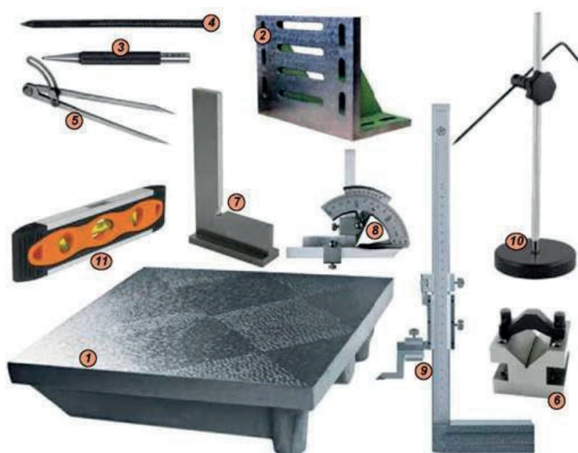
Рис. 1.4. Інструменти для розмічання: 1 – розмічальна плита; 2 – розмічальне пристосування; 3 – кернер; 4 – рисувалка; 5 – розмічальний циркуль; 6 – призма для фіксації круглих заготовок; 7 – слюсарний кутник; 8 – пристосування для вимірювання кутів; 9 – штангенінструмент; 10 – рейсмус; 11 – водовага
