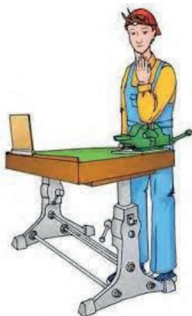
Рис. 1.3. Регулювання висоти слюсарних лещат
