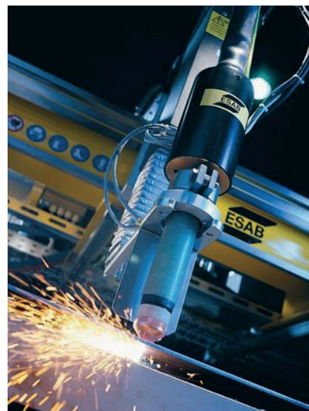
Рис. 2.2. Плазмове різання матеріалів
