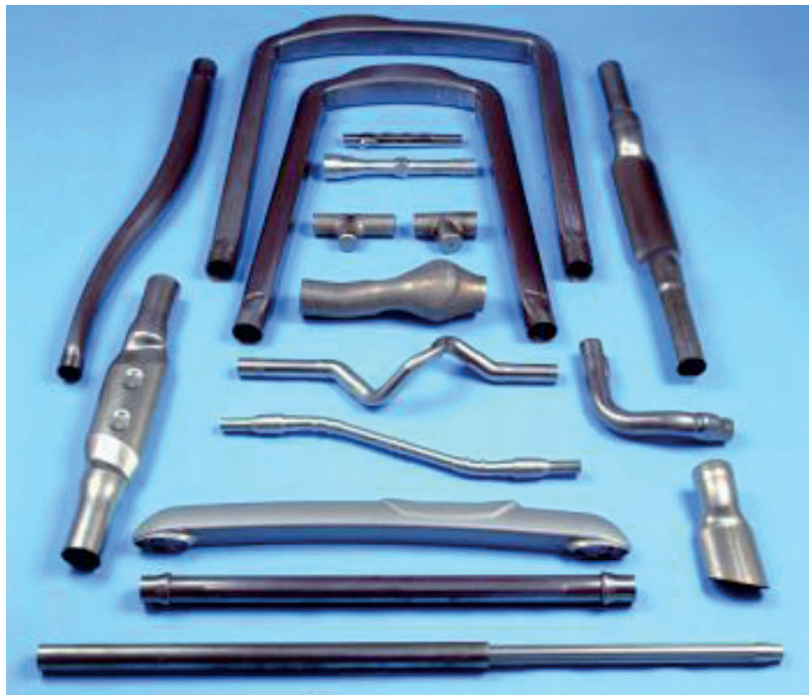
Рис. 2.8. Деталі виготовлені гідроформуванням
