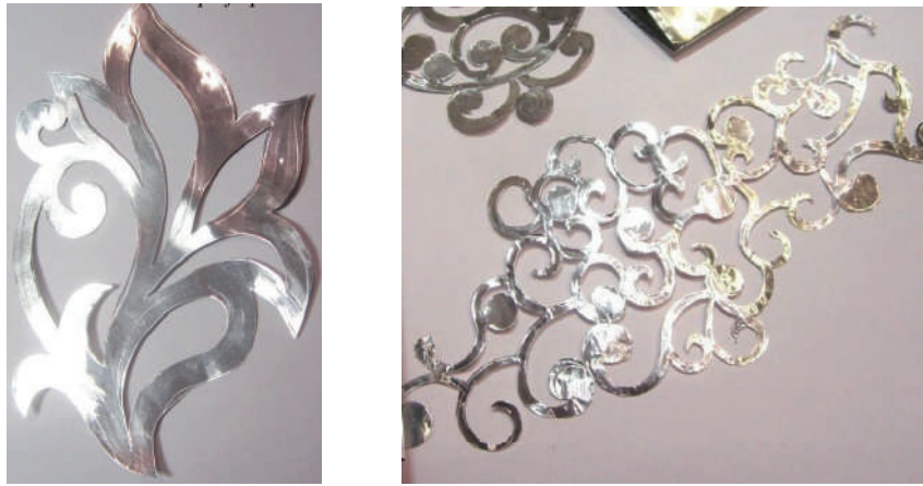
Рис. 1.10. Багаторазові трафарети, виготовлений з алюмінієвої фольги
